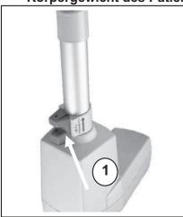
Die Notabsenkung kann bei Stromausfall oder entleerter Batterie über den roten Drucktaster ① am unteren Ende des Motors betätigt werden. Werkseitig ist diese Notabsenkung auf ein Patientengewicht von 75 kg eingestellt.
