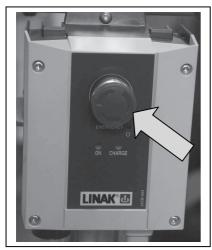
Bei Notfällen und während der Montage und Demontage muss der Notstopp durch Drücken des roten Knopf an der Kontrollbox aktiviert werden.
