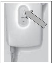
Lors de la charge des batteries, la diode supérieure est allumé avec un voyant jaune.
