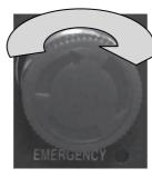
Der Notstopp wird deaktiviert, indem der rote Knopf in Pfeilrichtung gedreht wird.
