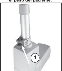
En caso de corte del suministro eléctrico o cuando las baterías estén vacías, la bajada de emergencia se puede realizar por medio del tirador rojo ① del extremo inferior del motor. Esta bajada de emergencia está configurada de fábrica para un peso del paciente de 75 kg.
