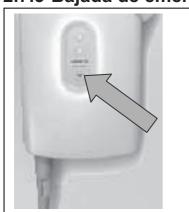
Si se produjera un daño en el mando manual, la pluma se puede bajar usando el panel de control.
