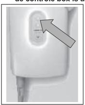
Tijdens het opladen van de batterijen zal de bovenste LED met een gele kleur oplichten.
