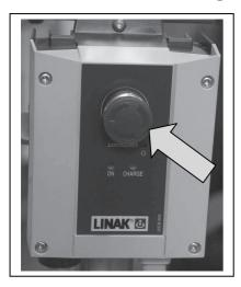
In caso di emergenza e durante il montaggio e lo smontaggio, è possibile attivare l'arresto di emergenza premendo il pulsante rosso a destra presente sulla centralina.
